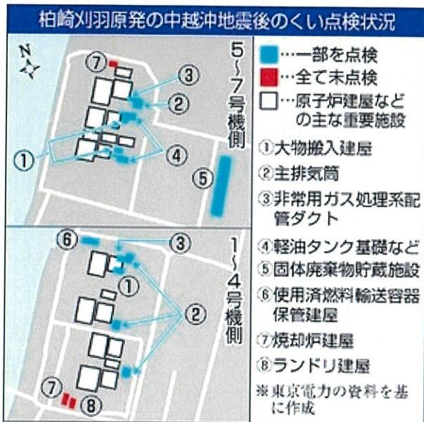
図8 柏崎刈羽原発の中越沖地震後のくいの点検状況
